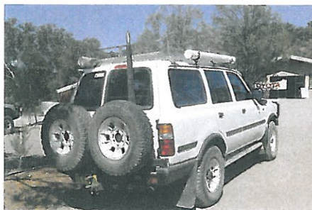
リアにスベアを2本背負い、HF無線機のアンテナを立てる典型的アウトバック・ツアーに仕立てられた80スタンダード。
