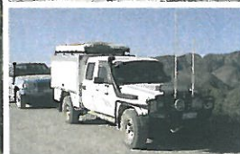
西オーストラリア州代表の自作キャン ンパー。HZJ75キャブシャーシーの フレームを延長しエクストラ・キャ ブに仕上げ、2台の冷蔵庫、熱交換 式のシャワーまで装備。快適なプ ッシュ・キャンプが可能だ。
