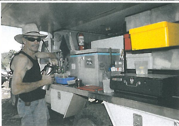
西オーストラリア州代表の自作キャン ンパー。HZJ75キャブシャーシーの フレームを延長しエクストラ・キャ ブに仕上げ、2台の冷蔵庫、熱交換 式のシャワーまで装備。快適なプ ッシュ・キャンプが可能だ。
