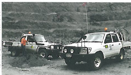
右はH Z J105を改造したデュアルキャブユート。後部座席後ろでボディを取り付けてある。左の新型V8ターボディーゼルのV DJ 79は人気が高く納車が追いつかない。
